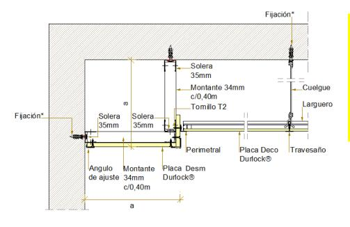
\* Se utilizarán tarugos de nylon con tope Nº 8 y tornillos de acero de 6mm de diámetro x 40mm, o brocas metálicas.
