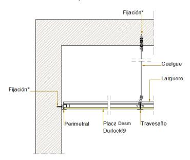
\* Se utilizarán tarugos de nylon con tope Nº 8 y tornillos de acero de 6mm de diámetro x 40mm, o brocas metálicas.
